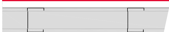
CW pojedyncza konstrukcja, np. SO-1 x g-k CW50
