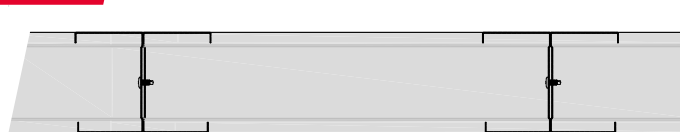
CW+CW wzmocniona konstrukcja, np. SO-1 x g-k CW50+CW50
