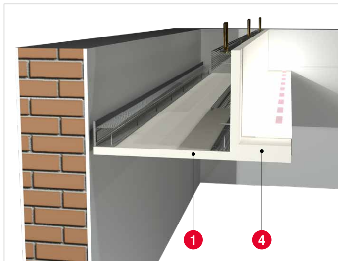
Rys. 20. Wykonanie oświetlenia LED na suficie
