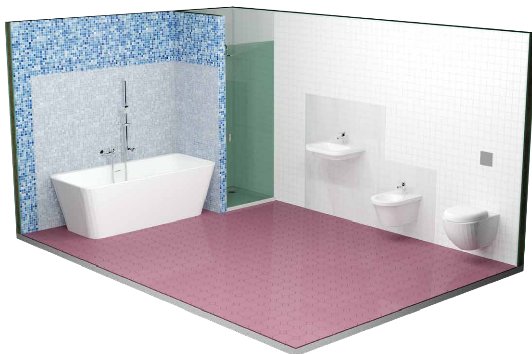
Rys. 37. Obszary ścian szczególnie narażone na działanie wody w łazience (zaznaczone kolorem szarym)
